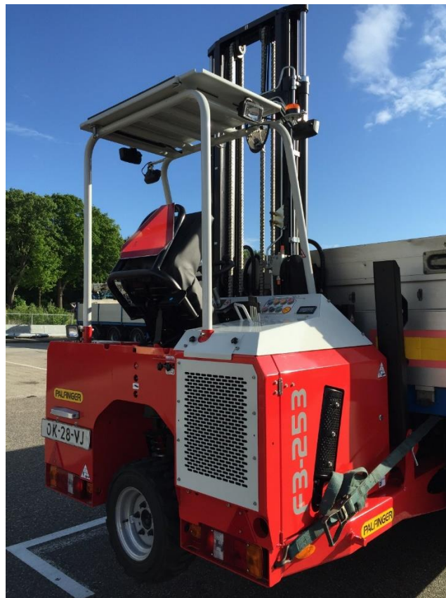
Merk: Palfinger kooiaap F3 253 PX 4W Hefvermogen 2500 kg
